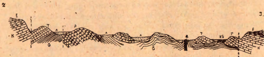
Presjek (2) dna depresije Kosova između Zvijerica i Markovca: P = šupljikavi stanični dolomit, G = naslage gipsa, T = donje werfenske naslage, E = prominke brečije i konglomerati, K = gornja kreda, Kb = kvarterne brečie i konglomerati, A = aluvijalni nanos, e = eruptivno kamenje.
