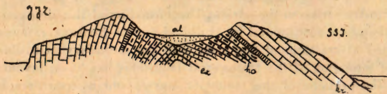
Presjek (6) otoka Šolte: ex=ekzogirski vapnenici, ko=hondrodonski vapnenici, kr=rudistni vapnenac, al=aluvijalni nanos.
