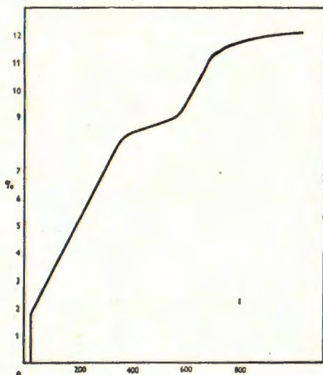
Sl. (fig.) 12. Dijagram termogravimetrijske analize limonita (getit + karbonati) sa V. etaže rudišta Kozin (Thermobalance curve of limonite [goethite + carbonates]; Kozin, V. level)
