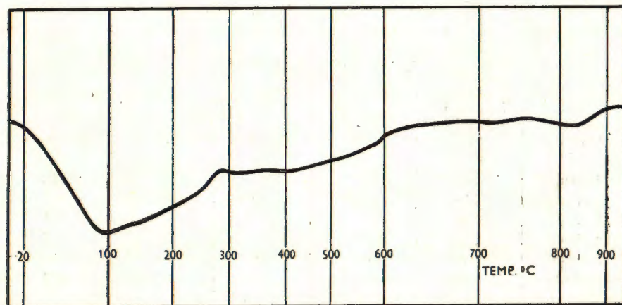
Sl. (fig.) 7. Dijagram diferencijalno-termičke analize netopivog ostatka limonita (montmorijonitske gline) sa II. etaže rudišta Brdo (D. T. A. of insoluble remnants from limonite [montmorillonitic clay]; Brdo, II. level)
