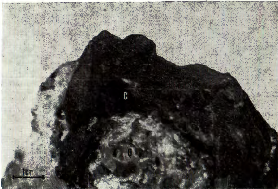
Slika 2: Uzorak 3; C — klorit, Q — kvarc, T — turmalin
