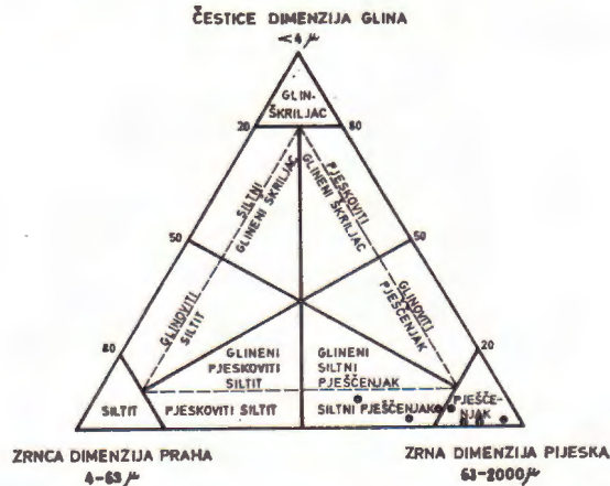
Slika 1. Klasifikacijski dijagram stijena serije: glineni škriljac—silit—pješčenjaka na temelju granulometrijskog sastava (K o n t a, 1973) sa položajem »maceljskih pješčenjaka«
