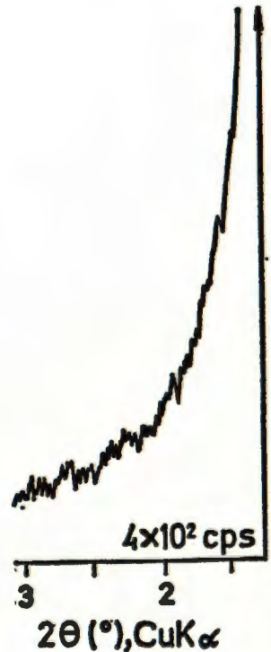
Sl. 3. Rendgenogram praha uzorka CP—3 (124,8 m) (čestice <4 \mu\text{m} ) kod malih difrakcijskih kutova. Brzina goniometra: 1/4^\circ (2\theta) na minutu.
