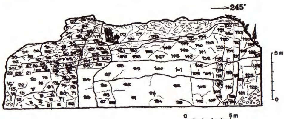
Sl. 5. Shematska skica raspucalosti stijenske mase (profil ucrtan na geološkoj karti, sl. 2)
